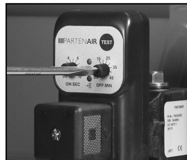
En suivant le taux de fonctionnement du compresseur et des conditions climatiques vous pouvez modifier ce réglage.
