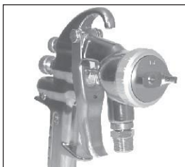
Jet plat vertical (chapeau horizontal)
