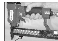
1c) Placer les pointes dans le bas du magasin.
