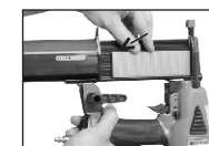
2c) Placer les agrafes dans le haut du magasin.
