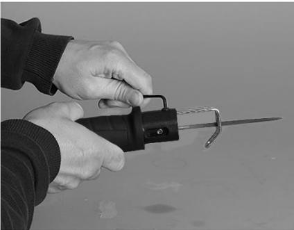
La scie est livrée de série avec un guide lame qui peut être réglé en longueur, il suffit :
