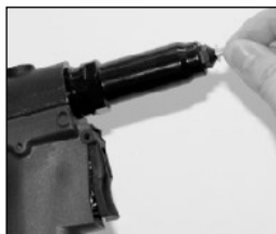
La tête du rivet doit toucher l'embout
