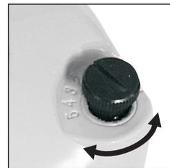
Le régulateur d'air est placé au niveau de l'inverseur de sens de rotation, à l'arrière de la clé. Il permet de régler le débit d'air à l'entrée de la clé à chocs. Plus le débit d'air est important, plus la clé aura de puissance et de couple (et ce à pression constante).
