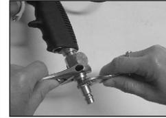
Monter le raccord rapide et le régulateur
