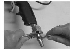
Monter le raccord rapide et le régulateur
