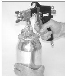
Pour fermer le pistolet, il suffit d'emboîter le couvercle avec le godet.
